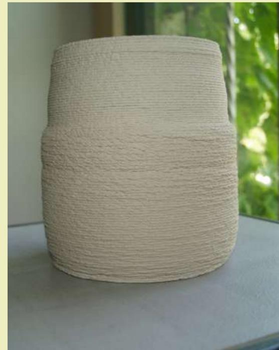
La miscela geopolimerica è il risultato di un processo di dissoluzione e polimerizzazione minerale che avviene a temperatura ambiente.
